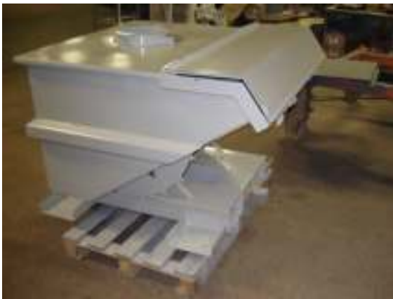
RP imukippikontti maalauksessa.
