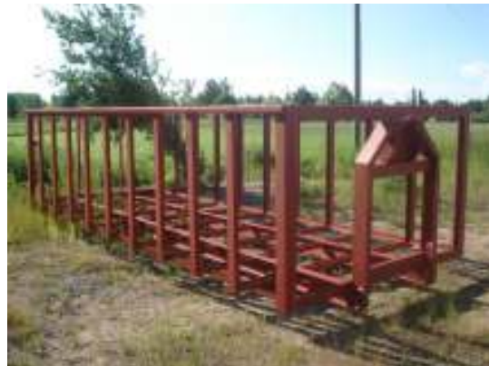
Kuvassa vaihtolavan runko puhallettuna ja maalattuna.
