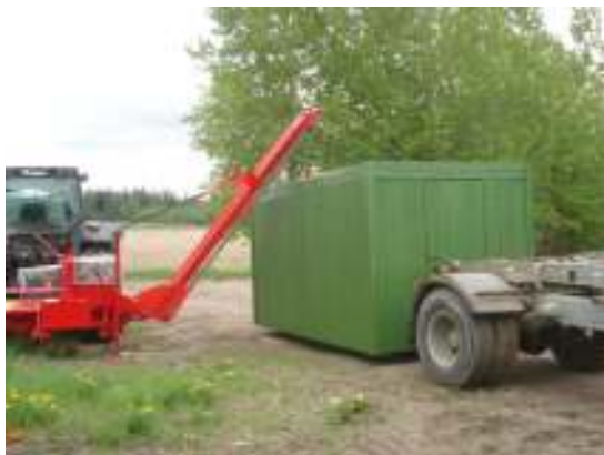
Puutavara saadaan helposti pilkottua suoraan konttiin, eikä klapityömaalle jää siivottavaa.
